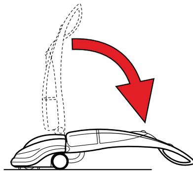
Altura mínima de trabajo 200 mm.: permite limpiar debajo de muebles, sillas, mesas, camas, etc. El mango reclinable garantiza el uso diario fácil y sencillo de la máquina. La gran capacidad de los tanques evita paradas frecuentes para llenar la unidad.
